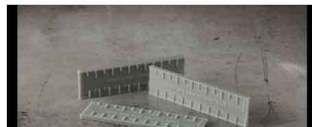
ファストモデルレジンで造形したくし状のテストピース
