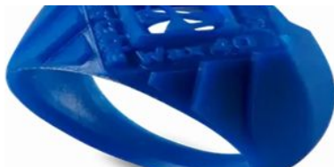
キャストابلワックス 40 レジンで造形した青いリングの原型
